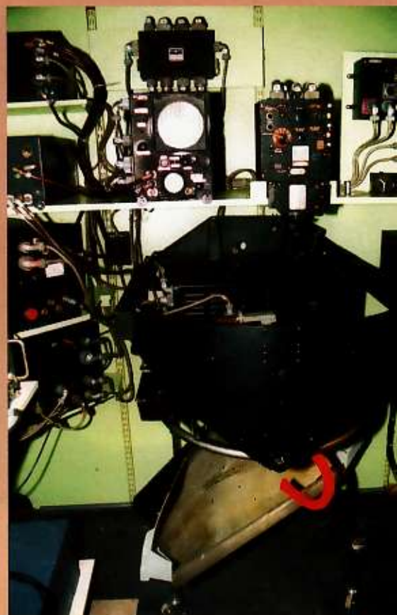
Deze Engelse ASV Mk7A Radar doet het na langdurige restauratiewerkzaamheden weer.
